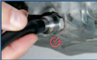
4. Schlauchanschluss mit viertel Umdrehung entriegeln und abziehen.
