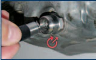
2. Schlauchanschluss aufstecken und mit viertel Umdrehung verriegeln.
