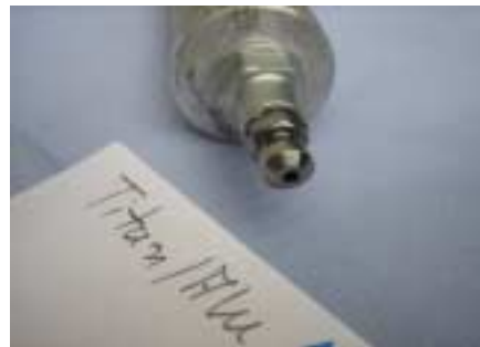
Prüfmuster Titan nach Abwischen der Salzreste.
